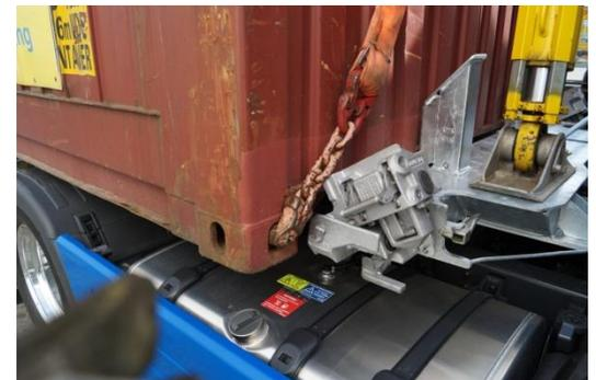
Speziell die Verriegelung im vorderen Chassis – Bereich wurde für die Anforderung eines Seitenlader – Umschlages adaptiert. Nutzlast 30to, alle Containertypen können manipuliert werden.
